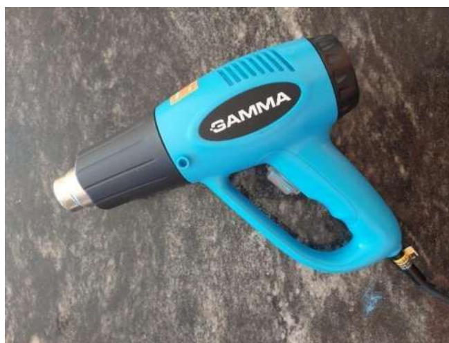
Soprador térmico para selar as capas de encáustica
