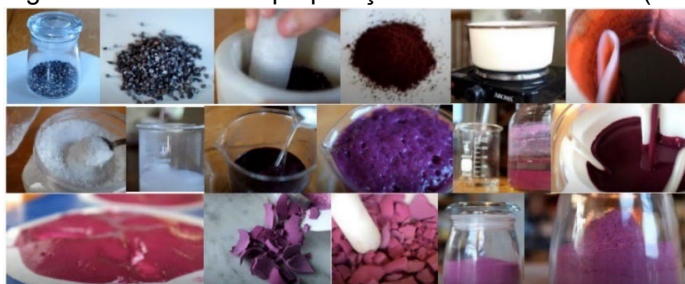
Figura 9: Processo de preparação do Cochineal Lake (carmim de cochonilha).
