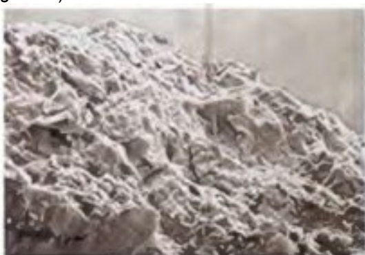
Figura 12: Micrografia de MEV da superfície superior de um fragmento de fundo de quartzo ( quartz ground ).
