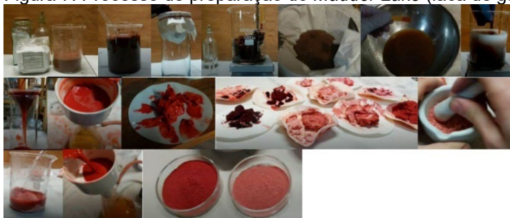
Figura 7: Processo de preparação do Madder Lake (laca de garança).
