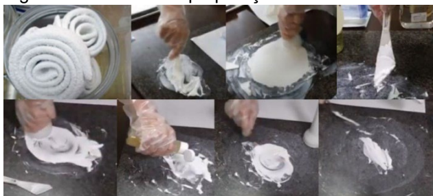
Figura 4: Processo de preparação do branco de chumbo, etapa final.
