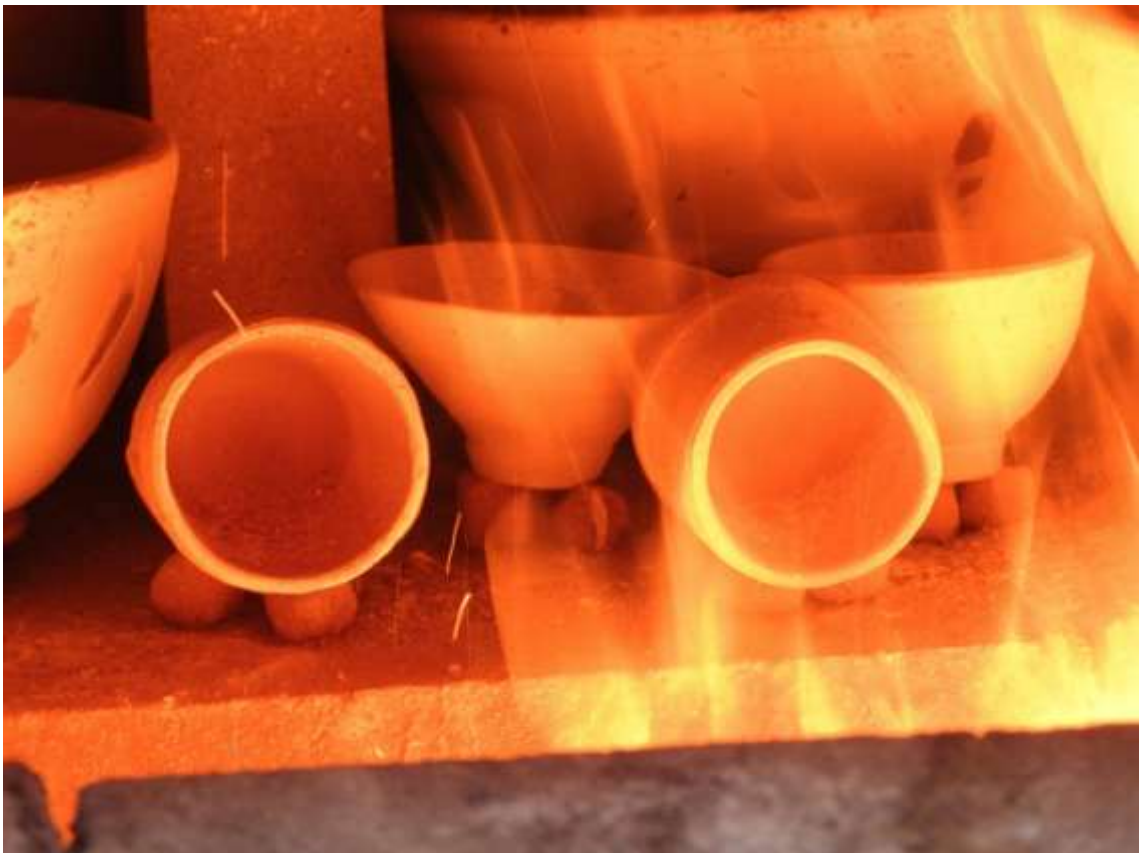
Fig.26 a 28 (p. 39-40) – Queima de cerâmica no forno anagama do Ateliê do Brejo em Silva Jardim-RJ. Arq. pessoal_2022
